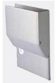
Die Profile werden in 25cm Abstand mit geeignetem Befestigungsmaterial fest verankert. Verzinkte Schwerlastanker sind für den Indoorbereich (Beton), Schwerlastanker aus Edelstahl für den Outdoorbereich (Beton), Klebe/Verbundanker für Mauerwerk etc. und Holzschrauben sind für die Befestigung an geeigneten Holzuntergründen vorgesehen.
