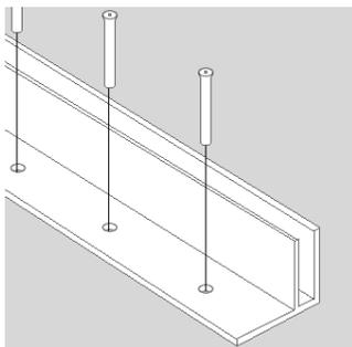
Die Profile werden in 25cm Abstand mit geeignetem Befestigungsmaterial fest im Boden verankert. Verzinkte Schwerlastanker sind für den Indoorbereich (Beton), Schwerlastanker aus Edelstahl für den Outdoorbereich (Beton), Klebe/Verbundanker für Mauerwerk etc. und Holzschrauben sind für die Befestigung an geeigneten Holzuntergründen vorgesehen.
