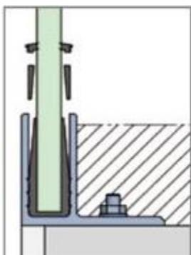
Im nächsten Schritt werden die U-Dichtungen, in die das Glas gestellt wird, alle 25cm in das Profil gesetzt und die Scheibe eingepasst. Die Fixierung erfolgt durch Kunststoffkeile, mit denen die Scheibe beidseitig fest eingeklemmt wird. Abschließend wird über die gesamte Länge die Abschlussdichtung eingesetzt.
