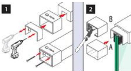
**1** Zuerst muss der Holzadapter akkurat am Holzhandlauf verschraubt werden. Dazu empfehlen wir die Verwendung einer Montagehilfe („Q-Tool“). Danach wird auf die **inneren** Kontaktflächen der Kleber aufgetragen (siehe oben) und das Verbindungsstück oder Endstück aufgesteckt und fixiert, bis der Kleber getrocknet ist.
