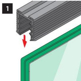
**1** Stecken Sie zuerst über die komplette Handlauflänge die Glasdichtung auf das gereinigte Glas.
